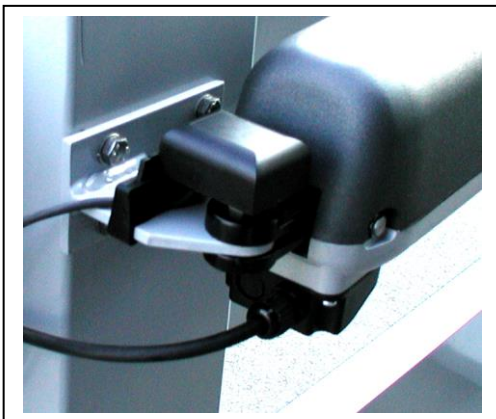
rückwärtige Antriebsbefestigung an der Torsäule (kann je nach Antriebsfabrikat variieren)
