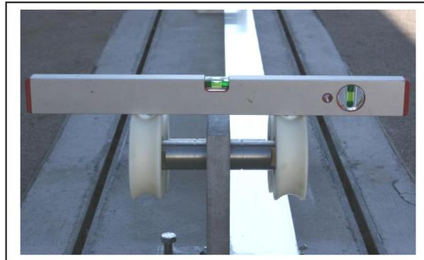
11. Festziehen der Ankermuttern und nochmaliges Kontrollieren der Rollenböcke.
